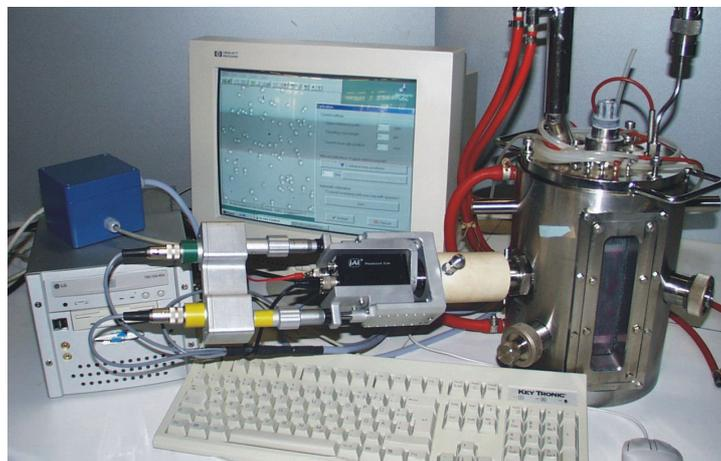
**Abbildung 2:** Das In-situ Mikroskop, eingesetzt in einen 1.5 L Testreaktor. Im Hintergrund auf dem Monitor ist die Steuersoftware erkennbar.
